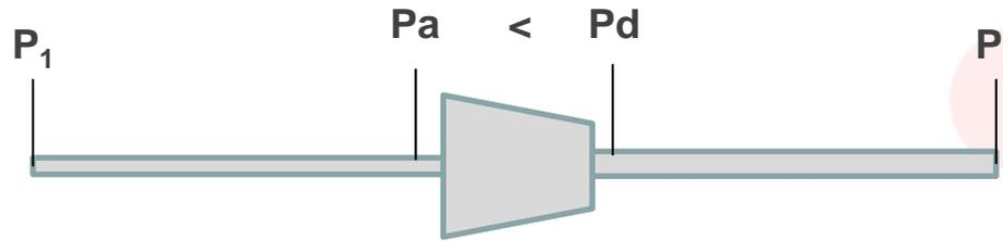
La potencia que deben suministrar las máquinas se calcularán a partir de las presiones de admisión y descarga de las mismas
