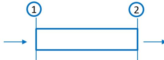
Tramo recto horizontal sin cambio de sección ni máquina
